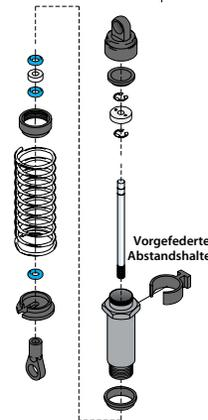
etwas über der Parallele zum Boden befinden. Beobachten Sie, wie sich das Modell in Kurven verhält. Die richtige Einstellung wird das Modell stabilisieren und Spin-Outs verhindern. Experimentieren Sie mit unterschiedlichen Federn und Stoßdämpferölen, um herauszufinden, was für Ihren Streckenbedingungen am besten funktioniert.
