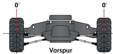
Stellen Sie nun den Servo und die Stangen so ein, dass beide Räder geradeaus nach vorne zeigen und zueinander parallel sind (0° Vorspur). Dies wird sicherstellen, dass das Modell in beide Richtungen gleich lenkt. Erhöhte Stabilität ergibt sich mit 1 bis 2 Grad Vorspur an jedem Vorderrad. Verwenden Sie zum Ausrichten die Spanschraube.
