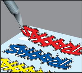
Zum Anbringen der Aufkleber setzen Sie eine Ecke an, halten das andere Ende hoch und streichen den Aufkleber dann mit Ihrem Finger in Richtung des anderen Endes. So vermeiden Sie die Bildung von Luftblasen unter dem Aufkleber. Wenn Sie zwei Ecken gleichzeitig aufsetzen und dann versuchen, den Aufkleber zu glätten, werden Sie Lufteinschlüsse unter dem Aufkleber erhalten. Die Fotos auf der Verpackung zeigen typische Positionen für die Aufkleber.
